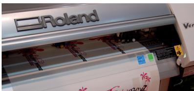
La testina piezoelettrica utilizzata sulla serie VersaCMM è un classico della stampa digitale. Dotata di una raffinata tecnologia costruttiva e di un affidabile circuito di controllo, può gestire elettronicamente la dimensione della goccia (variable droplet) così come la sua forma, che rimane netta e priva di satelliti.
